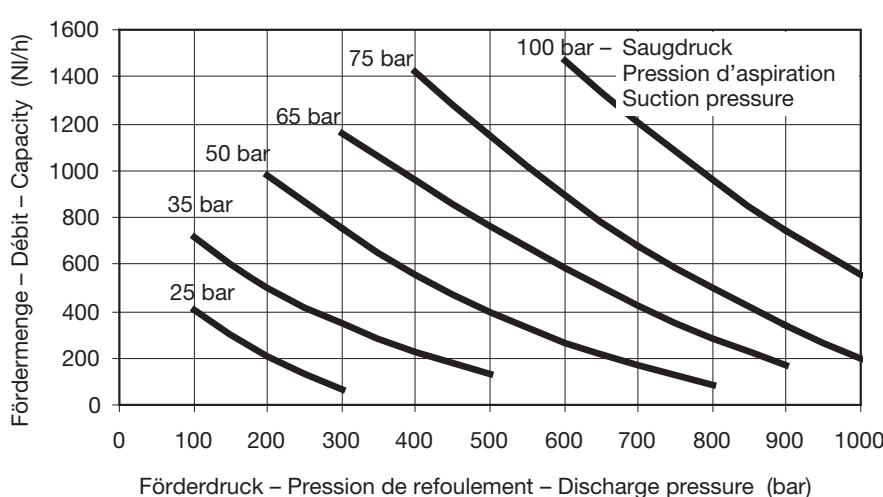
Fördermenge (Nm<sup>3</sup>/h) in Abhängigkeit des Saugdruckes und des Förderdruckes, gemessen mit N<sub>2</sub> bei Druckluftversorgung von 6 bar.
