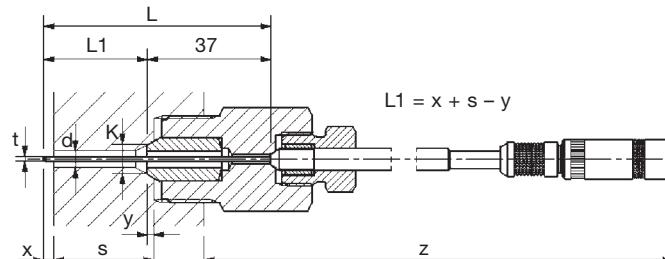
**Thermoelemente (Typ K + Typ J)****Thermocouples (Type K + Type J)****Thermocouples (type K + type J)****Pt100-Widerstandsthermometer (2-Leiter-Technik)****Pt100 resistance thermometers (two-wire system)****Thermomètres à résistance Pt100 (technique des 2 fils)**
