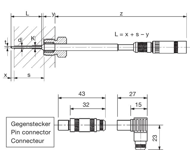
**Modell 2 – Design 2 – Modèle 2**
